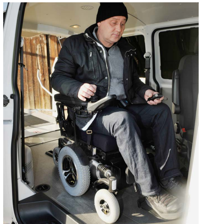
Mittels Fernbedienung öffnet er die Hecktüre und betätigt den Hecklift. Das Docking-System am Boden sichert den Rollstuhl während der Fahrt.
