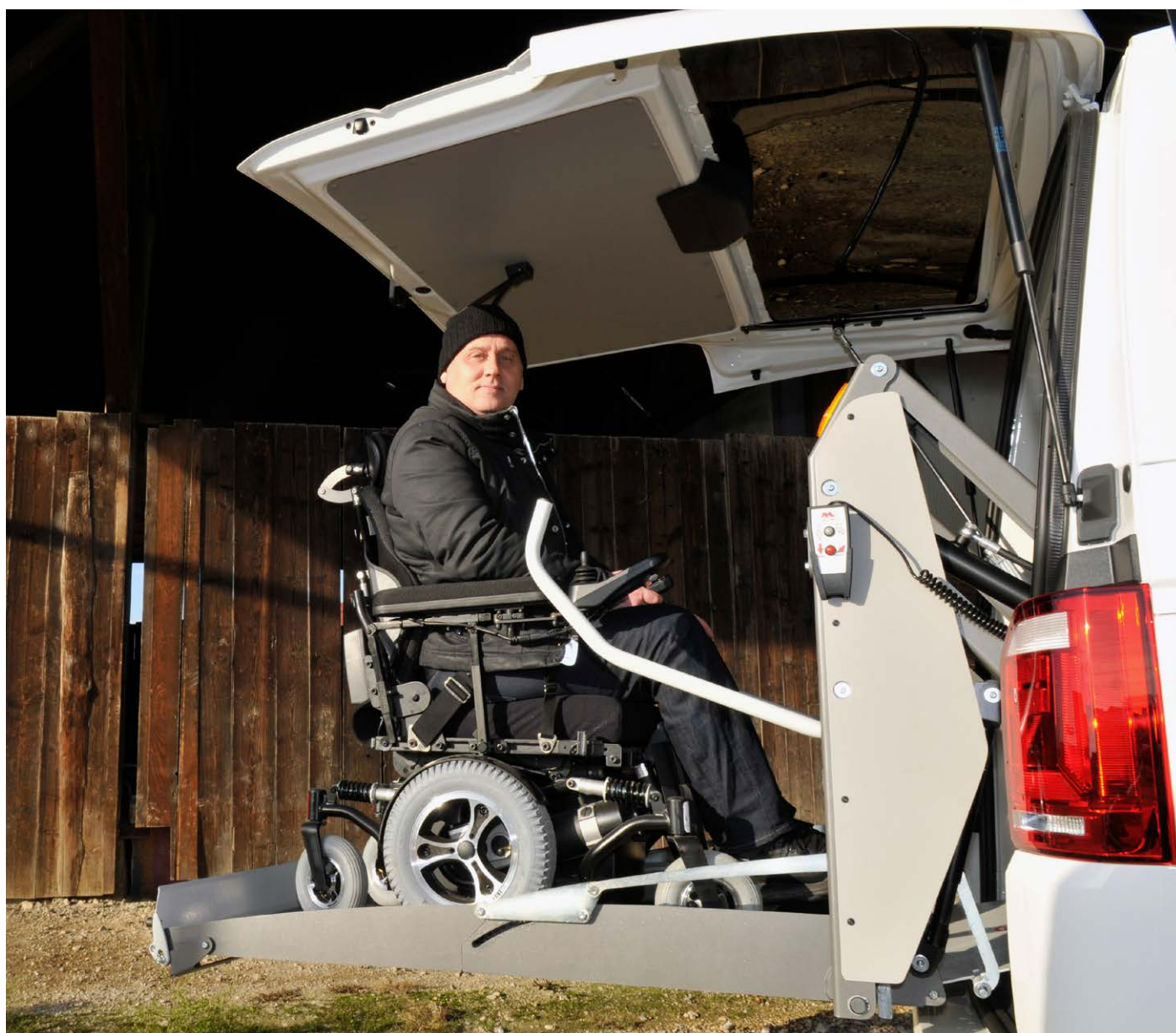
Ins Innere des Fahrzeugs gelangt Walter Marti über die herunterklappbare Rampe.
