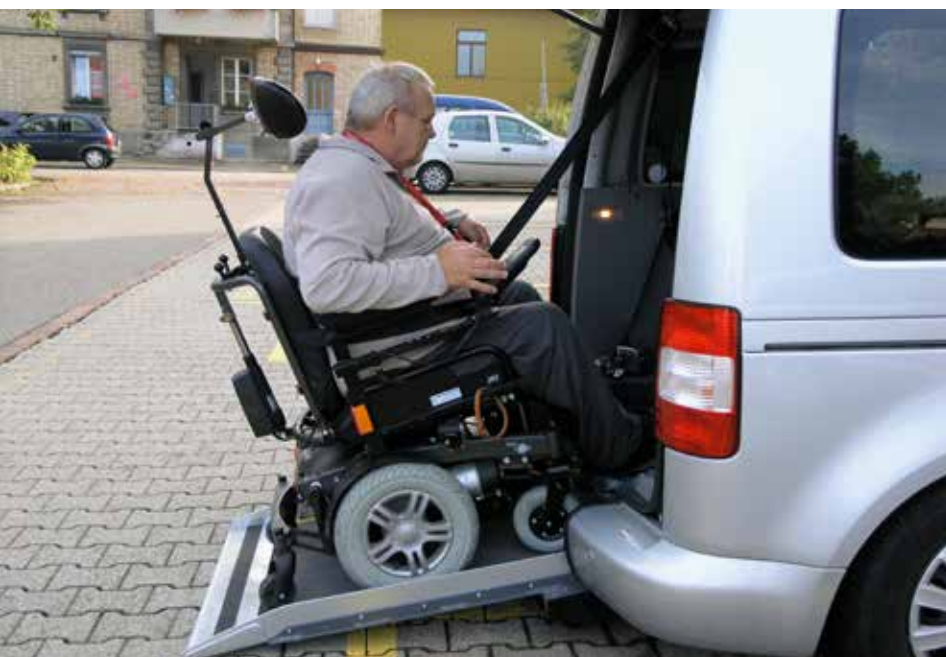
Über die Rampe fährt Heinz Blank mit seinem elektrischen Rollstuhl ins Fahrzeug.
