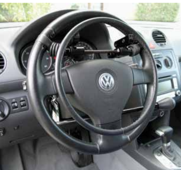
Das Auto fährt mittels Gasring und Bremse, die am Lenkrad platziert sind.
