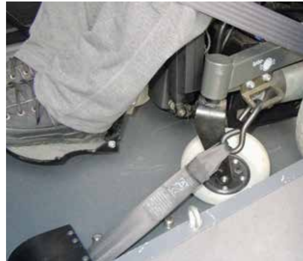
Heinz Blanks Rollstuhl wird über eine Halterung vorne zusätzlich gesichert.
