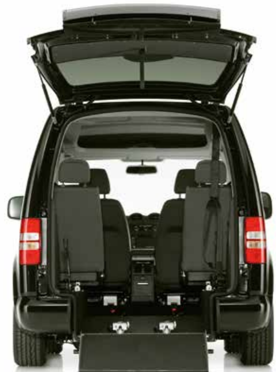
Die Auffahrtrampen gibt es in verschiedenen Längen. Sie richten sich nach der Höhe der Ladekante, dem Gesamtgewicht des Rollstuhlfahrers und den Möglichkeiten der Hilfspersonen (Bild 9).
