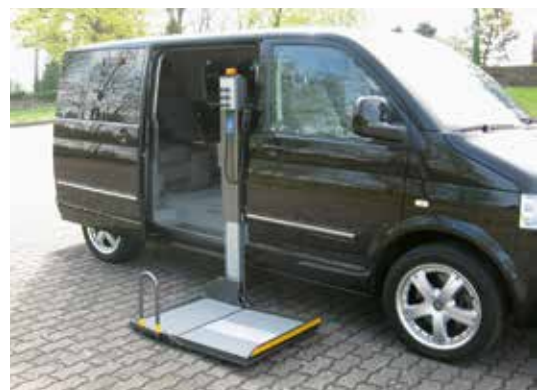
Für schwere Personen oder Elektrorollstühle kann auch ein Linear- (Bild 7), ein seitlicher Schwenk- (Bild 8) oder ein Kassettenlift eingebaut werden.
