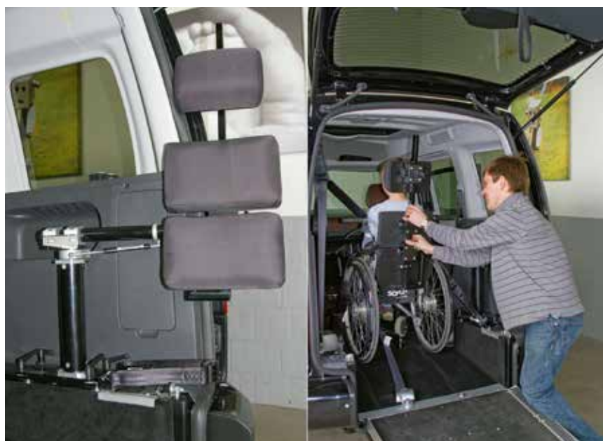
Auf dem Markt sind zusätzliche Rückhaltesysteme erhältlich, welche wesentlich besser schützen als herkömmliche Rollstuhlrücken. Dies können wegschwenkbare Kopf- und Rückenprotektoren (Bild 12) sein.
