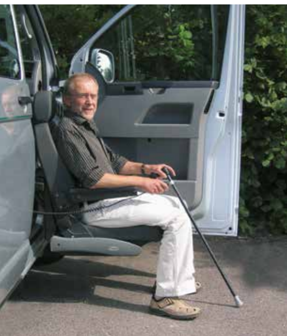
Schwenk-Hebesitze kann man auf die Sitzhöhe des Rollstuhls absenken, was den Transfer erleichtert (Bild 4).
