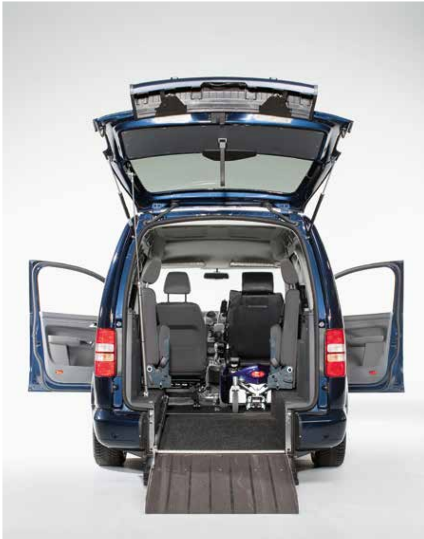
Es ist auch möglich, bei einigen Modellen den ganzen Fahrzeugboden tieferzulegen, so dass der Rollstuhl auf der Beifahrerseite Platz hat. Diese Variante ist aber sehr kostspielig (Bild 10).
