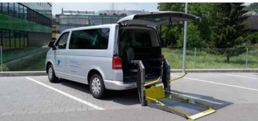
Für schwere Personen oder Elektrorollstühle kann auch ein Linear- (Bild 7), ein seitlicher Schwenk- (Bild 8) oder ein Kassettenlift eingebaut werden.
