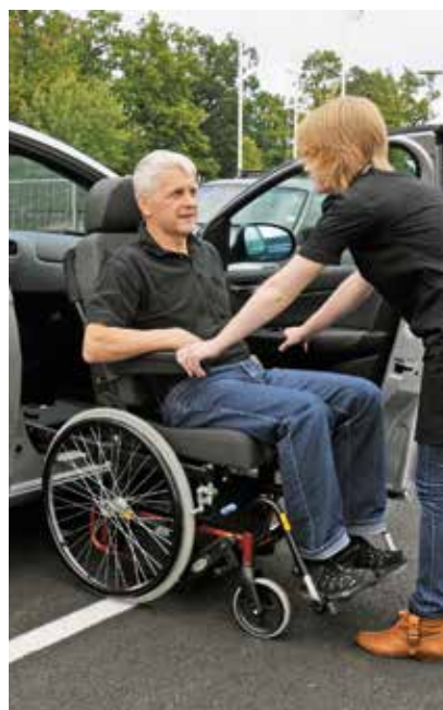
Zum Schwenk-Hebesitz ist ein Rollstuhluntergestell erhältlich, auf welches der Autositz zusammen mit der Person umgesetzt wird (Bild 5).
