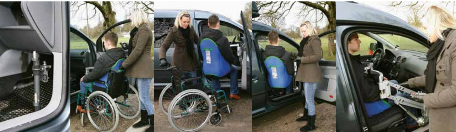
Personentransferlifte, welche mit einer elektrischen Hebevorrichtung die behinderte Person vom Rollstuhl auf den Autositz transferieren (Bilder 2,3).
