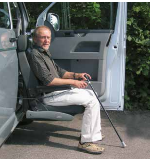
Ces sièges de transfert (photo 4) peuvent s'abaisser à la hauteur d'assise du fauteuil roulant, ce qui facilite considérablement l'opération.
