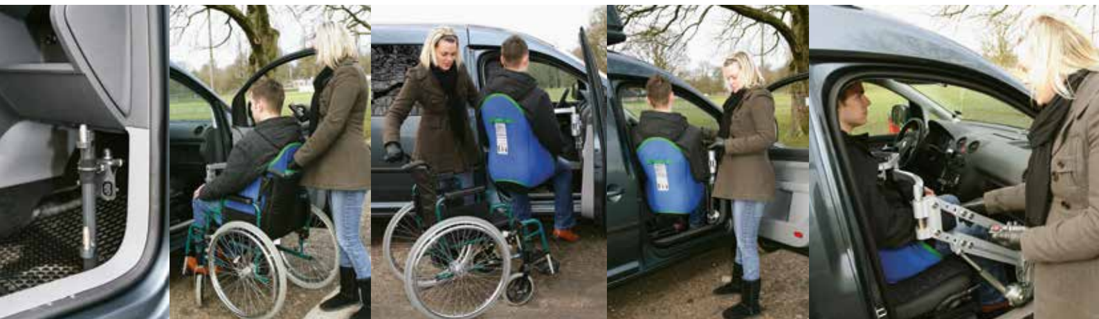
Les soulèves-personne (photos 2, 3) qui permettent de transférer la personne handicapée du fauteuil roulant au siège de voiture à l'aide d'un dispositif de levage électrique est une solution plus technique.
