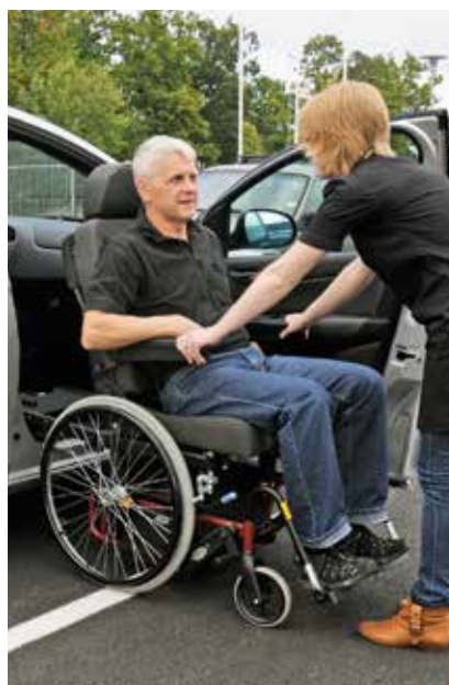
En plus du siège de transfert, une embase sur roues (photo 5) est également disponible pour recevoir le siège de voiture et son passager.
