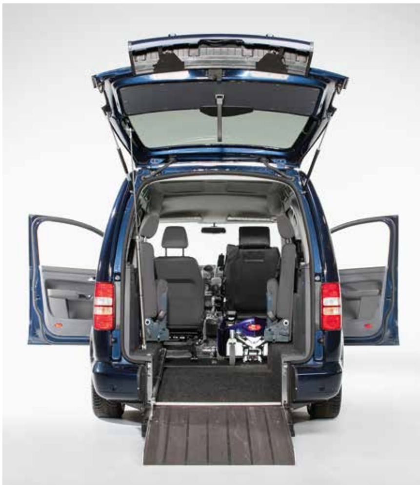
Certains modèles permettent également d'abaisser l'intégralité du châssis afin que le fauteuil roulant puisse voyager à l'avant à côté du conducteur. Cette variante n'est cependant pas très bon marché (photo 10).
