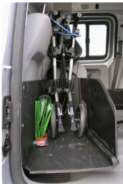
Un dispositif spécial est installé pour le déambulateur et le fauteuil roulant de Madame Blank.
