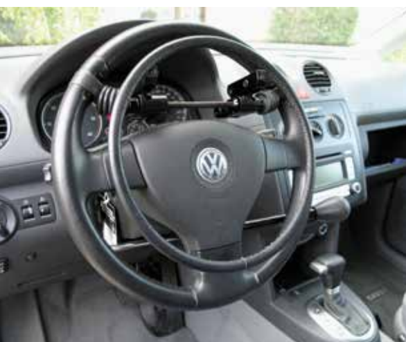
La voiture se conduit grâce à un cercle accélérateur et des freins placés au niveau du volant.
