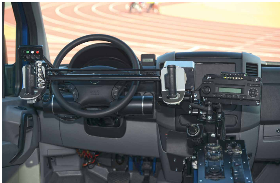
Bild 1: Mit einem Joystick kann man ein Auto einhändig oder mit beiden Händen steuern.
