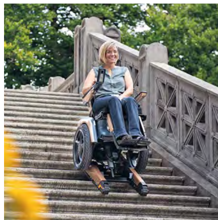
Bild 1: Bequem und stabil gerade Treppen hoch und runter fahren – die integrierten Raupen machen es möglich.
