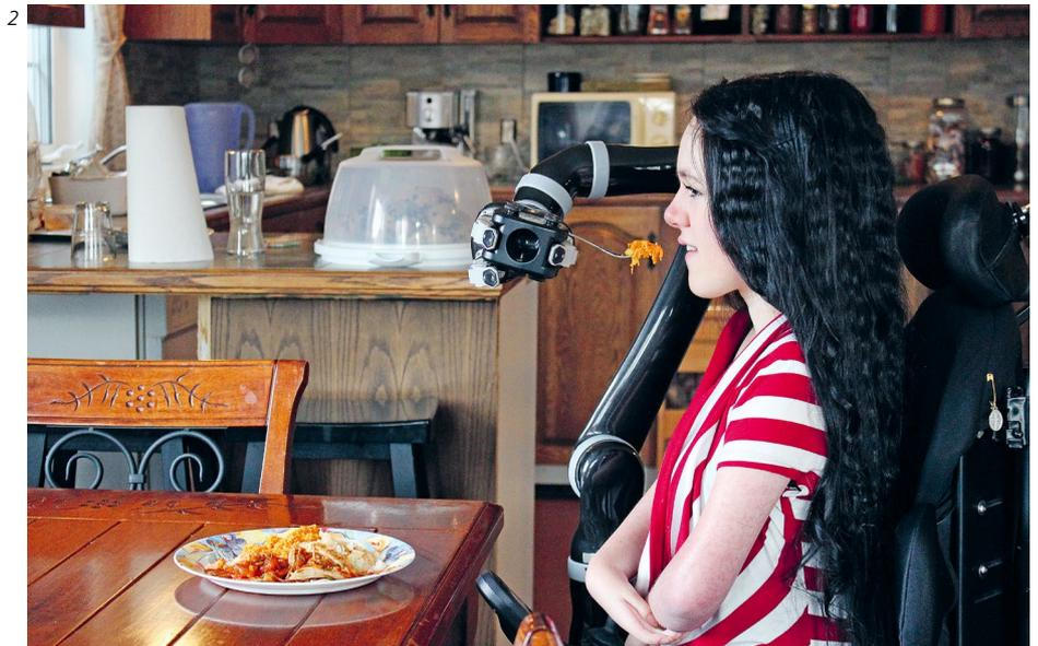
mini-joysticks, des commandes par souffle et aspiration, des commandes par la tête, des interrupteurs ou des interfaces d'assistance. Le fauteuil roulant tout comme le bras robotisé sont ainsi commandés à l'aide d'un seul appareil, ce qui constitue une solution souple pour les handicaps moteurs les plus divers.
